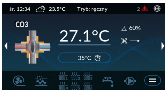
Rysunek 7: Ekran siłownika zaworu 4D dla obwodu CO3.
